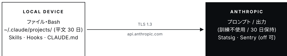
Fig. 2 Claude Code のデータフロー。ローカルのファイル操作・Bash 実行は端末に留まり、プロンプトと出力だけが TLS で Anthropic に送られる。
